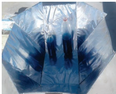
Figura 4. Concentrador de irradiación solar empleado en los ensayos de degradación
